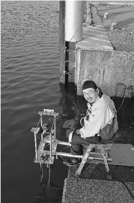
Fig. 1 ワイヤー式水位計（可搬式）。
